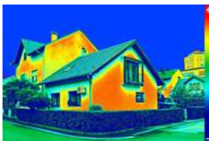
Слика 5 – Термовизијско праћење квалитета термоизолације [8]
