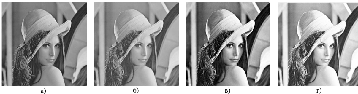
Слика 1 – Тест слике: а) Lena и слике након корекције: б) TGC, в) THE и г) AGC алгоритма.
